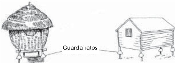
Pode-se fazer guarda ratos com uma lata rasa ou cortada ao topo. A lata deve ter a forma de cone com um furo no centro. Amarre-a com pregos ou arame a volta dos pés do abrigo da semente.
