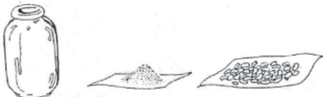
Para este teste utiliza-se um frasco seco, limpo com tampa, sal e uma amostra de semente de feijão
